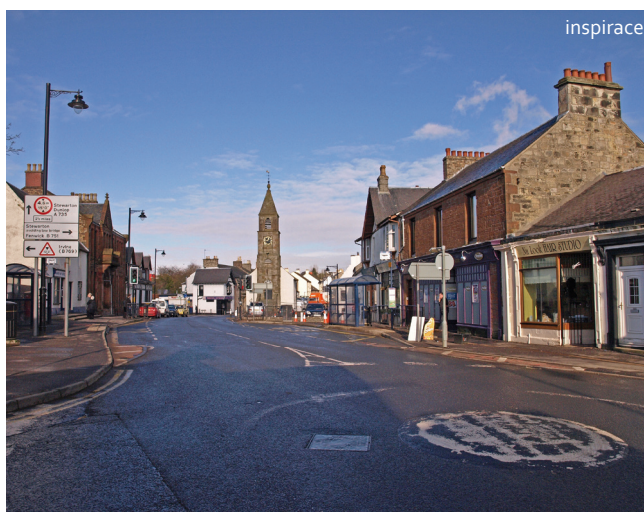
Obrázek 56 Příklad miniokružní křižovatky v Kilmaurs, Spojené Království, zdroj: wikipedia, 2010
